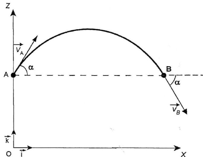
Figure 1. Trajectoire du centre d'inertie G de l'avion
