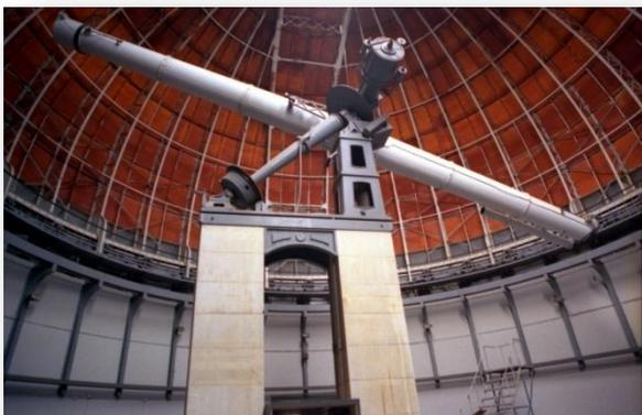
La grande lunette de l'observatoire de Nice, grâce à son objectif de distance focale 17,89 m (de diamètre 83 cm) et à ses oculaires de 10 mm et 8 mm, permet des grossissements de 1800 à 2000.
