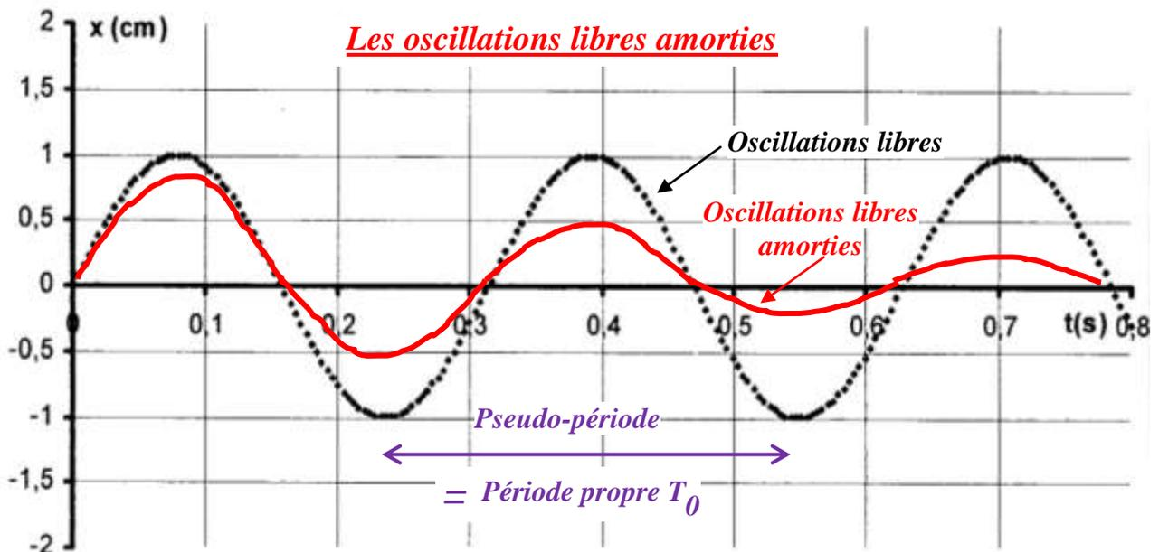
Dès l'apparition d'un **frottement fluide ou solide**, le régime d'oscillations devient **pseudo-sinusoïdal**. L'amplitude des oscillations diminue selon la qualité et le type de frottements (importants ou faibles, fluides ou solides). En cas de faibles frottements, la **pseudo-période** est égale à la **période propre  $T_0$**  de l'oscillateur. Elle augmente dans le cas contraire, voire même disparaît lors du **régime aperiodique**.
