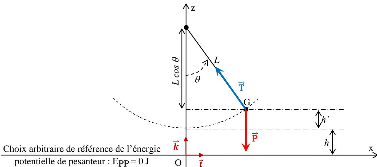
L'énergie mécanique du système {pendule-Terre} est somme de l'énergie cinétique (liée à la vitesse) et de l'énergie potentielle (liée aux forces qui travaillent au cours du déplacement) :
