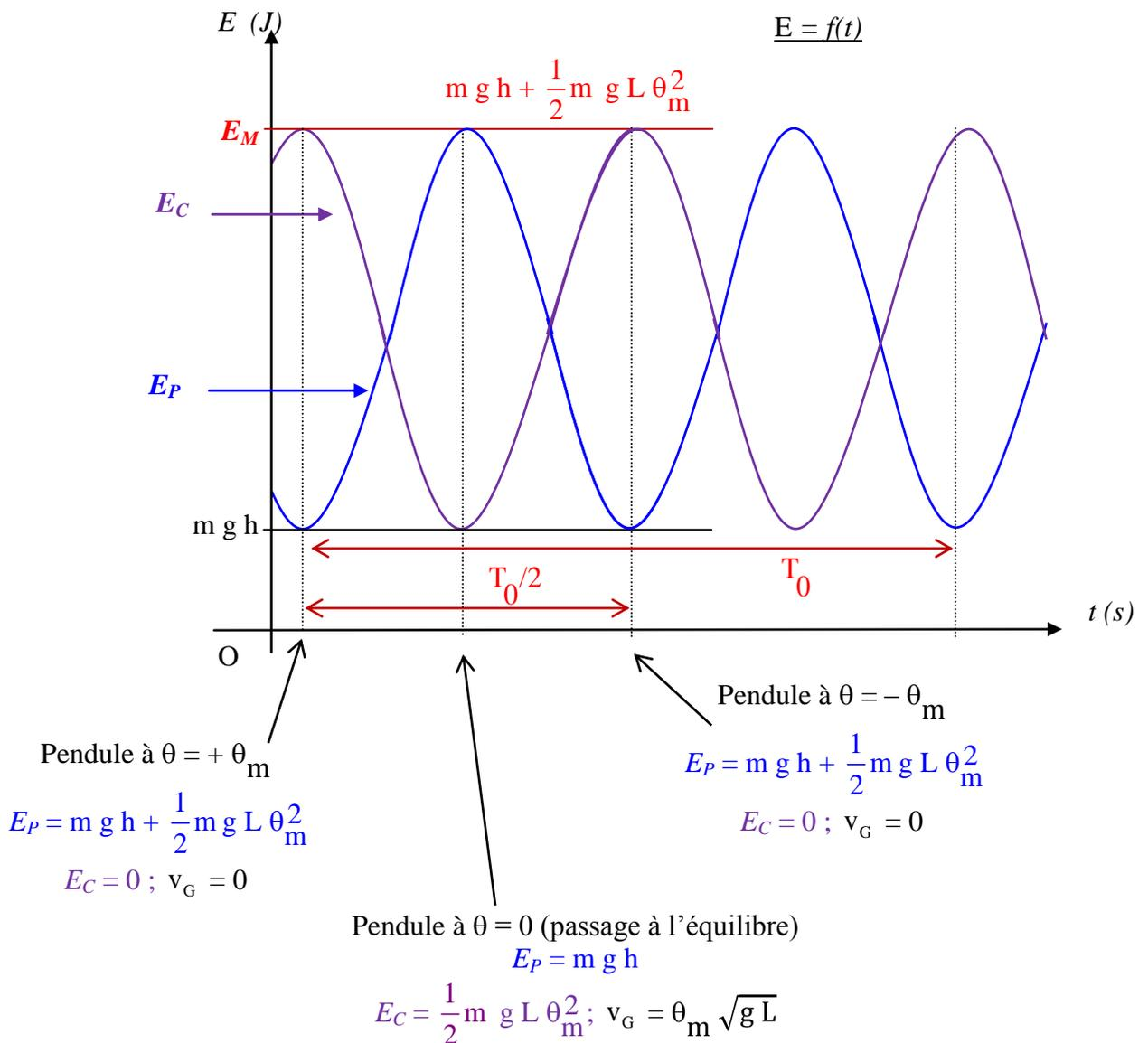
Il y a transformation permanente de l'énergie sous formes cinétique et potentielle de pesanteur à une fréquence double de l'oscillation du pendule. Sans frottement aucune perte d'énergie n'est dissipée vers l'extérieur, le pendule acquiert sa vitesse maximale au passage à la verticale d'équilibre et poursuit sa course dans cet allant incessant.
