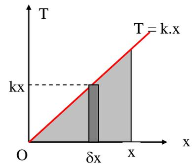
L'énergie potentielle élastique  $E_{pe}$  du système {masse - ressort} est égale au travail W de la force  $\vec{F}$  soit :  $E_{pe} = \frac{1}{2} \cdot k \cdot x^2$  à une constante additive près choisie nulle
