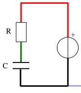
Lors de l'établissement du courant dans un circuit comportant une lampe en série avec un condensateur, on constate un retard à l'allumage. Le système ainsi constitué a donc une évolution temporelle particulière. Les caractéristiques d'une lampe sont celles d'une résistance avec l'éclairement en moins. On étudie alors « le dipôle R, C »
