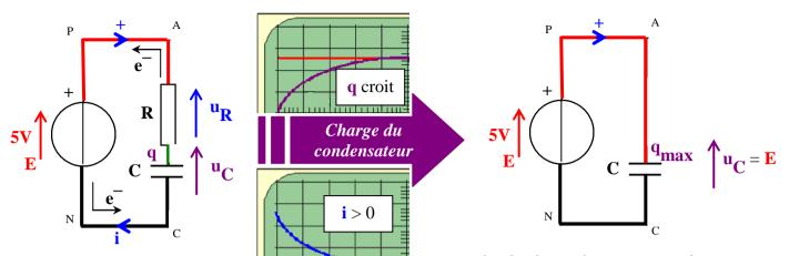
Le condensateur se charge : Le temps nécessaire est fonction de la capacité C du condensateur, mais aussi de la résistance R qui « résiste » aux déplacements des électrons.
