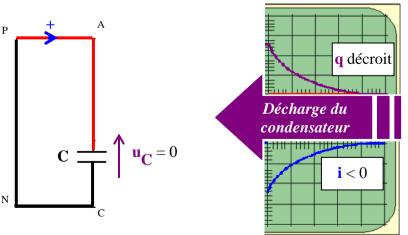
En fin de décharge la tension aux bornes du condensateur est nulle, identique à celle du générateur. La tension est de nouveau nulle aux bornes de la résistance.
