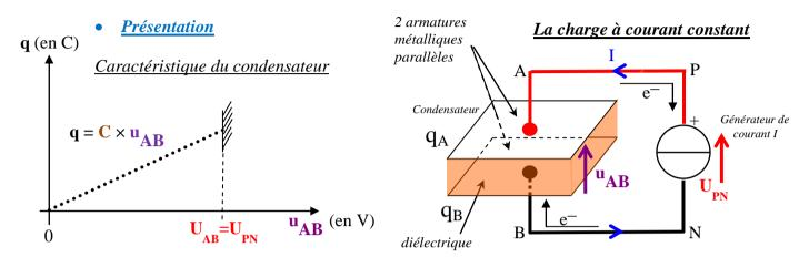
Lorsque **l'armature B** est soumise au potentiel négatif du générateur de courant, elle « condense » les électrons, sa charge est  $q_B = n \times (-e)$  est négative (« -e » est la charge de l'électron, «  $e = 1,6 \times 10^{-19} C$  » la charge élémentaire et « n » le nombre d'électrons).
