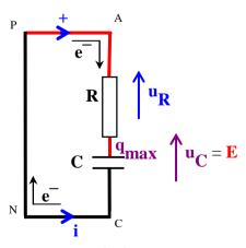
Le condensateur se décharge : Le temps nécessaire est fonction des mêmes capacité **C** et résistance **R** caractéristiques du circuit
