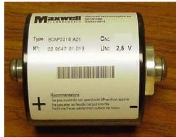
Pour étudier un tel condensateur de capacité  $C$ , on le monte dans un circuit en série avec un conducteur ohmique de résistance  $R = 1,0 \Omega$ . On considèrera qu'à l'instant  $t = 0$ , date de basculement de l'interrupteur de la position 1 à la position 2, le condensateur est totalement chargé sous une tension  $E = 2,5 \text{ V}$ .
