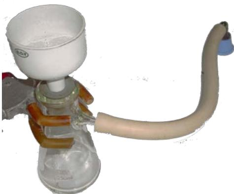
Enfin, réaliser une filtration sous vide à l'aide d'un büchner, de papier filtre et d'une fiole à vide.
