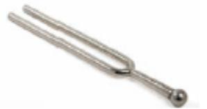
La vibration des deux lames, engendrée par un choc, produit un son presque pur de fréquence déterminée.
