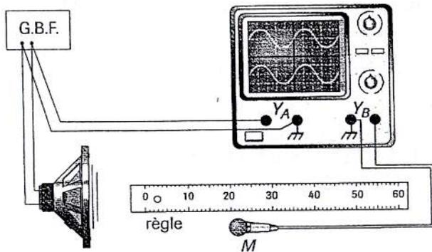
On positionne le micro en face du zéro de la règle, et on déplace l'ensemble {règle, micro} devant le HP jusqu'à ce que les deux courbes soient en phase. On fixe alors la règle, et on recule le micro jusqu'à ce que les courbes soient de nouveau en phase (pour la première fois) ; on lit alors  $d$  sur la règle.
