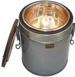
Les mesures **d'énergie thermique** s'effectuent dans un **calorimètre** thermiquement isolé, c'est-à-dire n'échangeant pas d'énergie avec le milieu extérieur.
